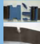
バックル・ ベルト破損
