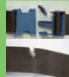
バックル・ ベルト破損
